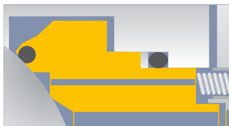
Dichtsystem: PMSS, primär metallisch/ sekundär weichdichtend
