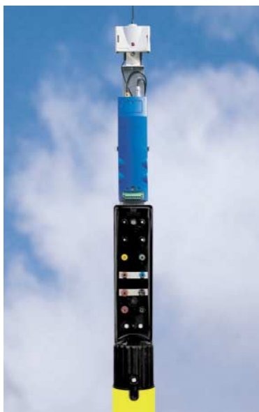
Messstellenpfosten für Funkübertragung
